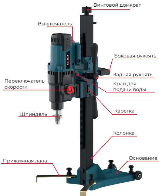
рис. 1: Схема машины алмазного бурения DD 44-300 NWE с обозначением частей
